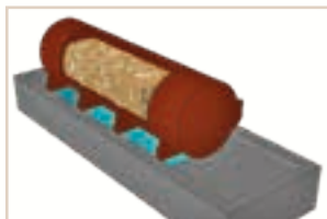
5: Le produit de préservation est évacué de la cuve
