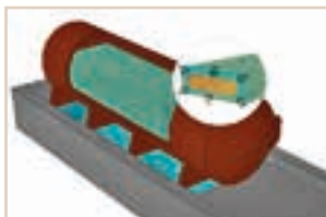
4: L'autoclave est mis sous pression pour forcer l'entrée du produit dans le bois.
