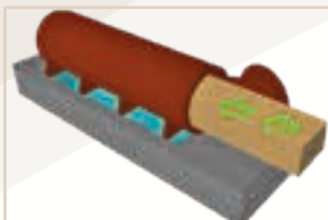
4: L'autoclave est mis sous pression pour forcer l'entrée du produit dans le bois.
